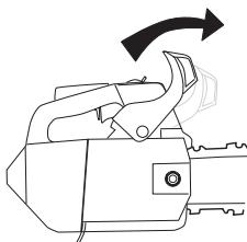
**Топливный насос:** Сожмите несколько раз резиновую грушу топливного насоса пока в неё не начнет поступать топливо. Грушу нет необходимости заполнять полностью.
