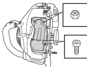
Глушитель служит для снижения уровня шума и отвода раскаленных выхлопных газов от рабочего. Выхлопные газы очень горячие и могут содержать искры, что может привести к пожару при прямом попадании на сухой и воспламеняющийся материал.
