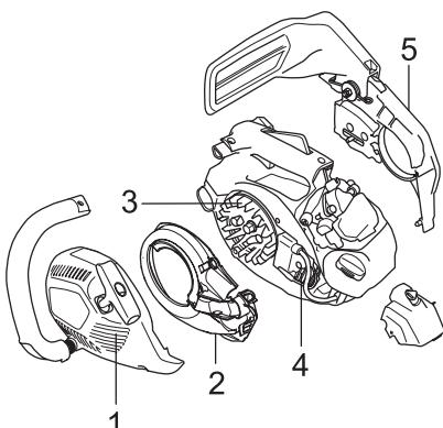
Производите очистку системы охлаждения щеткой раз в неделю или чаще, если этого требуют условия работы. Загрязненная или засоренная система охлаждения может привести к перегреву машины и вызвать повреждение поршня и цилиндра.
