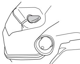
Используйте ту же процедуру, что и при холодном двигателе, но без постановки воздушной заслонки в закрытое положение.
