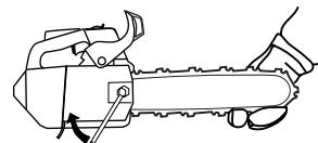
При установке новой цепи следует часто проверять ее натяжение, пока цепь не приработается. Регулярно проверяйте натяжение цепи. Регулярно проверяйте натяжение цепи. Правильно натянутая цепь обеспечивает высокое качество пиления и дольше служит.
